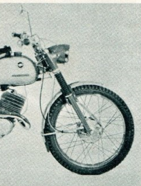
Diese beiden Gesamtansichten der neuen GS 125 von Zündapp zeigen deutlich die Verwandtschaft mit den serienmäßigen KS-Modellen: Zentralrohrrahmen mit im Bogen vom Steuerkopf zur Hinterradschwingelagerung führendem, großdimensioniertem Rohr, an das die Heckrohrkonstruktion hier anstelle des Druckgußteiles angeschweißt ist.
