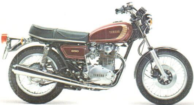
XS650. 2-Zyl.-4-Takt-OHC-Motor, 653 ccm, 50 PS (36,8 kW) bei 6.800 U/min, E-Starter, 173 km/h, 5 Gänge, 2 Scheibenbremsen vorn. Rot, Schwarz. DM 5.598,-*
