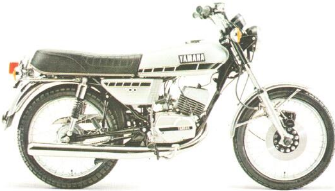
RS100. 1-Zyl.-2-Takt-Motor, 95 ccm, 10 PS (7,4 kW) bei 7.600 U/min, 96 km/h, 5 Gänge, Scheibenbremse vorn. Blau, Silber. DM 2.150,-*
