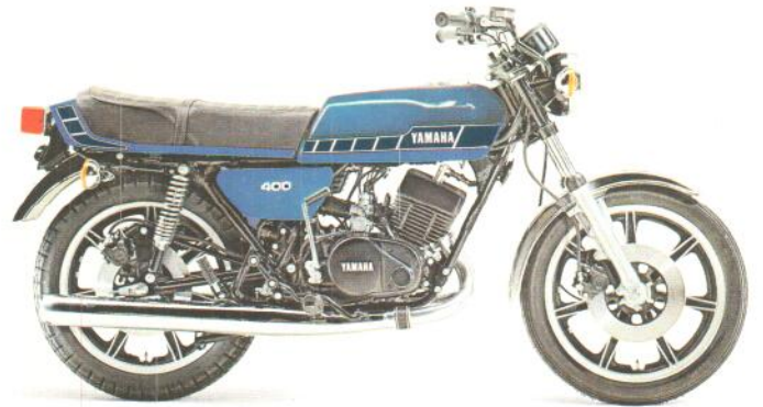
RD400. 2-Zyl.-2-Takt-Motor, 398 ccm, 43 PS (32,4 kW) bei 7.500 U/min, 162 km/h, 6 Gänge, Scheibenbremsen vorn und hinten. Blau. DM 4.600,-*
