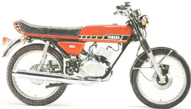
RD50 M. 1-Zyl.-2-Takt-Motor, 49 ccm, 3,0 PS (2,2 kW) bei 5.000 U/min, 40 km/h, 5 Gänge, Scheibenbremse vorn. Führerscheinklasse 5. Rot, Blau, Schwarz. DM 2.050,-*
