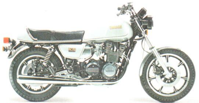
NEU XS1100. 4-Zyl.-4-Takt-DOHC-Motor, 1101 ccm, 95 PS (69,9 kW) bei 8.500 U/min, E-Starter, Kardan, 214 km/h, 5 Gänge, 2 Scheibenbremsen vorn und 1 hinten. Rot, Silber.
