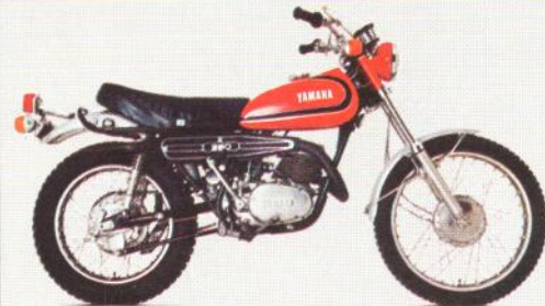
YAMAHA-ENDURO DT 250 Robust, sicher, wartungsarm. Wie jede YAMAHA-ENDURO. 1-Zylinder-2-Taktmotor. 5 Gänge. Telegabel mit 175 mm Federweg. Federbeine 5fach verstellbar. Farbe Rot.
