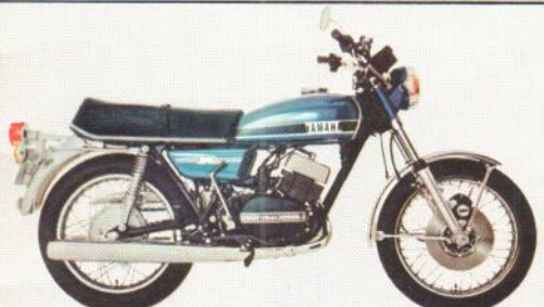
YAMAHA RD 250 2 Zylinder. 2-Takt/Parallel-Twin-Motor. 30 DIN-PS bei 7500 U/min. 5-Gang-Sportgetriebe. 0 auf 100 in 6,5 Sek. Spitze ca. 160 km/h. Hochwirksame Scheibenbremse. – Farben: Metallic-Blau und -Amber.
