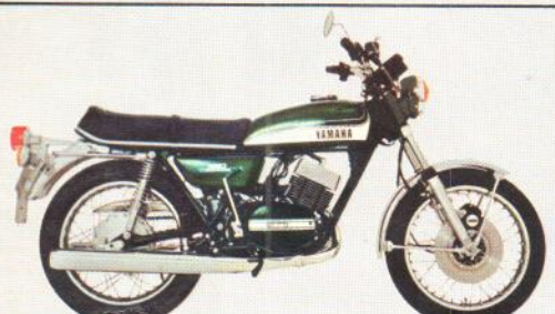
YAMAHA RD 350 2 Zylinder. 2-Takt/Parallel-Twin-Motor. 39 DIN-PS bei 7500 U/min. 5-Gang-Sportgetriebe. 0 auf 100 in 5,8 Sek. Spitze ca. 170 km/h. Sicherer Stop durch Scheibenbremse. Farben: Metallic-Grün und -Rot.
