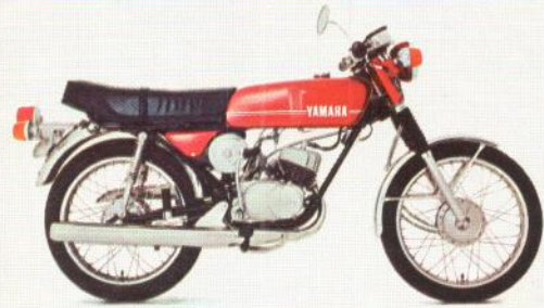
YAMAHA RD 50 1 Zylinder. 2-Taktmotor. 6,25 DIN-PS bei 8300 U/min. 5-Gang-Fußschaltung. Spitze ca. 95 km/h. Tacho, Drehzahlmesser und Blinkanlage. Farben: Metallic-Rot, -Braun und -Grün.
