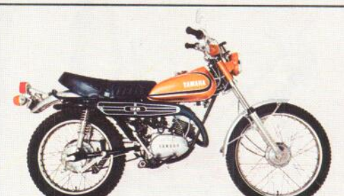
YAMAHA-ENDURO DT 125 E Unverwüßlicher 1-Zylinder-2-Taktmotor mit Elektro- und Kick-Starter. 5 Gänge. Abgestimmt für Straße und Gelände. Telegabel mit 145 mm Federweg. 5fach verstellbare Federbeine. Farbe: Metallic-Gold.
