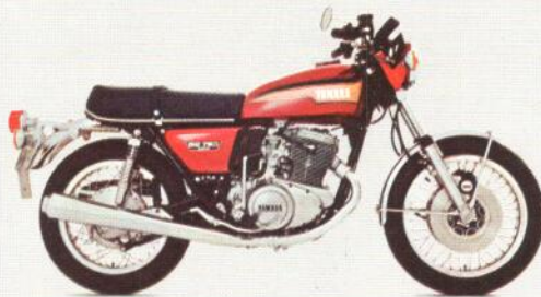
YAMAHA TX 750 4-Takt/2 Zylinder. Parallel-Twin-Motor. Vibrationsfrei. 51 DIN-PS bei 7200 U/min. 0 auf 100 in 6,0 Sek. Leichtmetall-Hochschulter-Felgen. Doppelscheibenbremse. Farben: Metallic-Rot, -Grün, -Gold.
