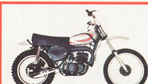
Weltmeister YAMAHA Die YZ 250: Die Moto-Cross-Weltmeistermaschine! Ausführung auch als YZ 125 und YZ 360. 1-Zylinder-2-Taktmotor mit Membraneinlaß. 5 Gänge.
